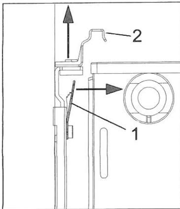
**D:** Zur Demontage des Heizkörpers Kunststoffversicherung (Pos.1) nach vorne drücken und oberen Halter (Pos.2) aus der Schiene soweit rausziehen, dass sich der Heizkörper abnehmen lässt.
