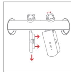
④ Passen Sie die Position des SwitchBot-Vorhang so an, dass er senkrecht zum Boden steht, und stellen Sie sicher, dass das Logo nach innen zeigt.
