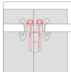
⑤ Beziehen Sie sich auf die Bilder unten, installieren Sie die Perlenbefestigung oben an der Tülle (mit den darin installierten Perlen), stellen Sie sicher, dass Sie sie fest an der Tülle befestigen. Schneiden Sie zum Schluss die restlichen Perlen ab oder legen Sie sie hinter Ihren Vorhang.
