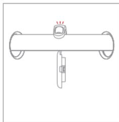
③ Stecken Sie den Hauptteil (der mit dem anderen Haken befestigt ist) auf die Stange, ziehen Sie den Haken nach unten und montieren Sie ihn auf dem Hauptkörper, Sie hören ein Klicken, wenn er fest sitzt.
