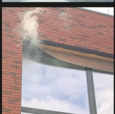
An der Gebäudehülle Überprüfung der gesamten Gebäudehülle mittels Blower Door Test
