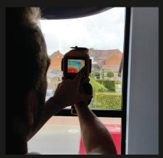
In der Bauanschlussfuge Überprüfung mit dem SFS Leak Finder mittels Ultraschall
