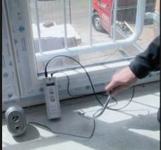
In der Bauanschlussfuge Überprüfung mittels Nebelmaschine
