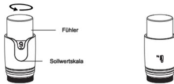
Drehen Sie den Sensor an jedem Heizkörper mit einem TRV, um die Temperatur zu steuern. Die Einstellungen werden mit Zahlenanstatt Temperaturangaben markiert.
