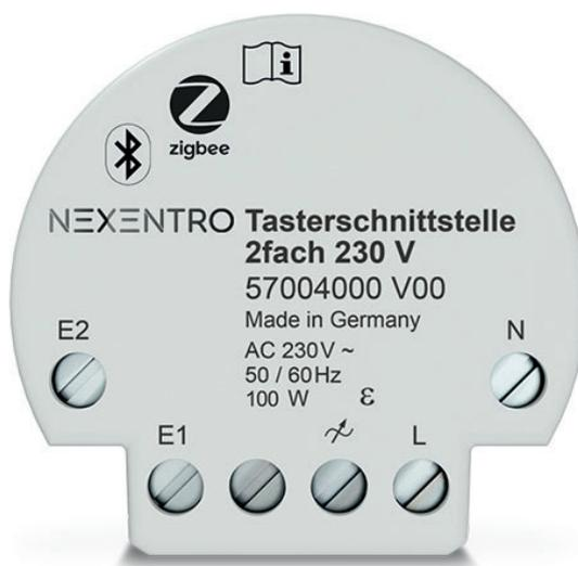
Tasterschnittstelle zur Funkbedienung von Zigbee-konformen Geräten, z. B. Lampen, Leuchten, Zwischensteckern, Dimmern, und Jalousieaktoren. Das Modul besitzt zwei Eingänge zum Anschluss von Einfach- und Serienschaltern oder Tastern. Die Installation erfolgt in der Gerätedose hinter dem Schalter oder Taster.
