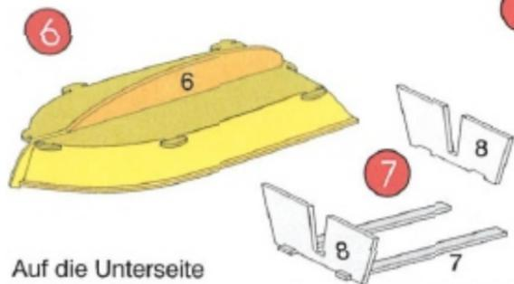
Auf die Unterseite wird der Kiel 6 aufgeklebt.
