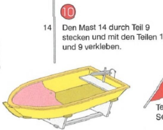
Den Mast 14 durch Teil 9 stecken und mit den Teilen 1 und 9 verkleben.
