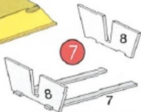
Aus den Teilen 7 und 8 wird der Bootsständer zusammengeklebt.
