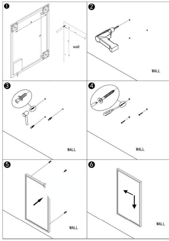
Schritt 1. Messen Sie den Abstand zwischen den Montagehaken und markieren Sie die Position an der Wand.
