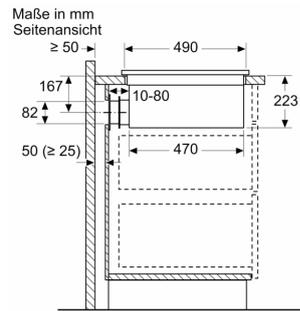
Bei der Installation direkt an einer nicht isolierten Außenwand ( $\mu \geq 0,5 \text{ W/m}^2 \text{ } ^\circ\text{C}$ ) empfehlen wir die Verwendung von Konfigurationen mit teilweise oder vollständig kanalisierter Rezirkulation.
