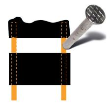
Keine Nägel oder Schrauben in die elektrischen Leitungen bohren!
