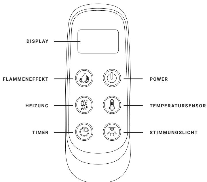
**HINWEIS:** Vergewissern Sie sich, dass die Batterien richtig in der Fernbedienung installiert sind. Die effektive Reichweite beträgt bis zu 4 Meter.
