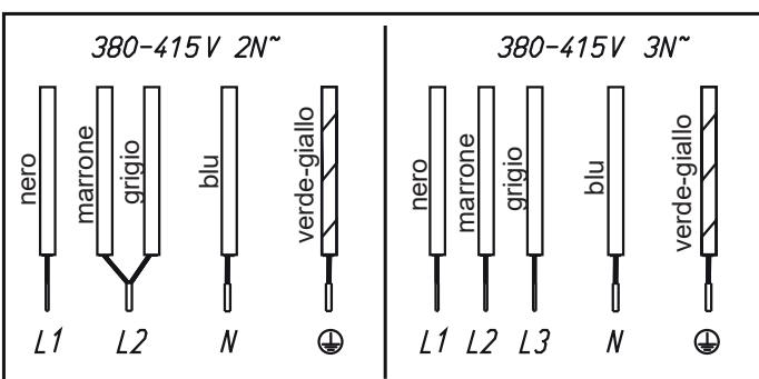
\* In Svizzera, questo modo di collegamento non è ammesso da parte del SEV.
