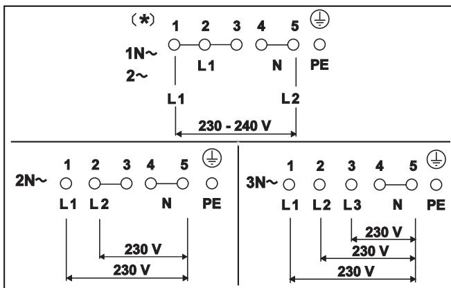
\* In Svizzera, questo modo di collegamento non è ammesso da parte del SEV.
