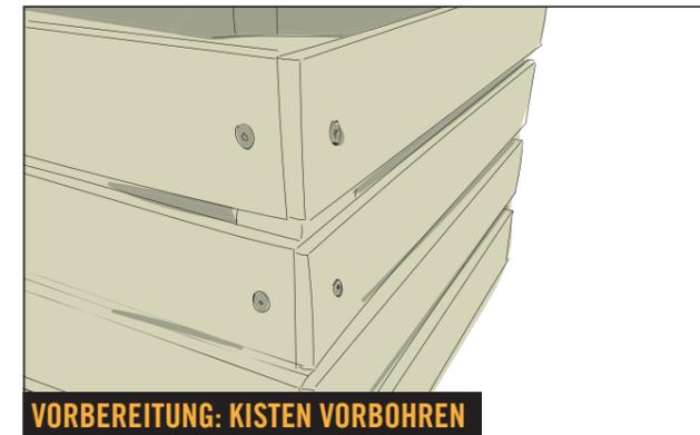
Zuerst jede Kiste stabilisieren: Alle Kisten vorbohren und anschliessend jedes Leisten-Ende mit je einer Schraube (4,5x20 mm) am Dreikantholz fixieren (ca. 25 mm vom Rand der Kiste entfernt).
