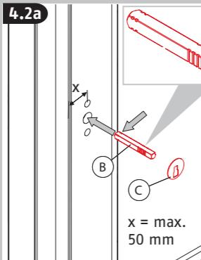
(DE) (B) mit der Kerbe voran bis zum Anschlag einsetzen und (C) aufsetzen
