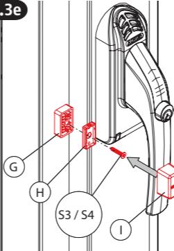
**i** (DE) Unterlage(n) und Magnethalterbefestigung an der markierten Stelle mit Schraube S3 / S4 anschrauben. Magnethalter I aufdrücken.
