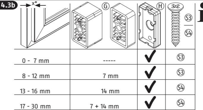
**i** \*x = Falzhöhe. Unterlagen müssen bündig mit der Flügeloberkante sein (DE)
