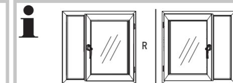
(DE) Anleitung zeigt die Montage an einem Fenster DIN rechts (R). Bei DIN linken Fenstern erfolgt die Montage seitenverkehrt.
