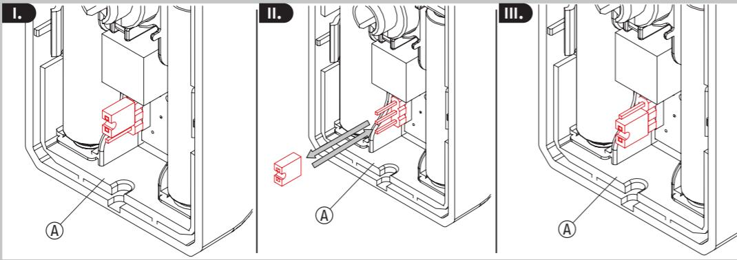
(DE) I: Standard-Bestätigungston und LED aktiv, II: Brücke wechseln, III: Option-Bestätigungston und LED inaktiv
