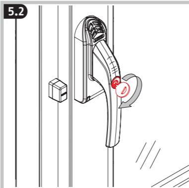
**i** (DE) Öffnen aus der Verriegelung mit Schlüssel. Dadurch wird der Alarm / die Überwachung deaktiviert.
