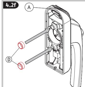
(DE) Wenn Durchmesser der Befestigungslöcher im Fenster > 12 mm sind, Ausgleichsringe (D) verwenden
