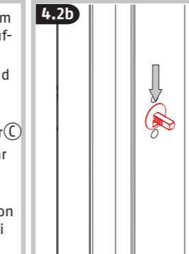
(DE) (C) bündig mit Flügel in die Einkerbung schieben
